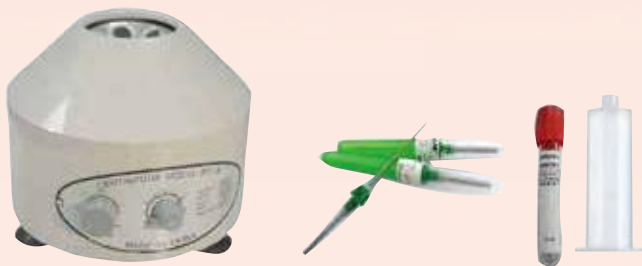
צנטרפוגה במהירות של עד 4,000 סל"ד 6x12 מיליטר עם מהירות מבוקרת וטיימר עד 30 דקות.
